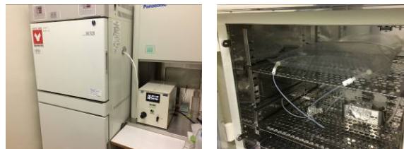
図 2 洗浄試験に用いた全自動加湿洗浄装置と恒温槽 (左) および洗浄中の恒温槽内の様子 (右)
