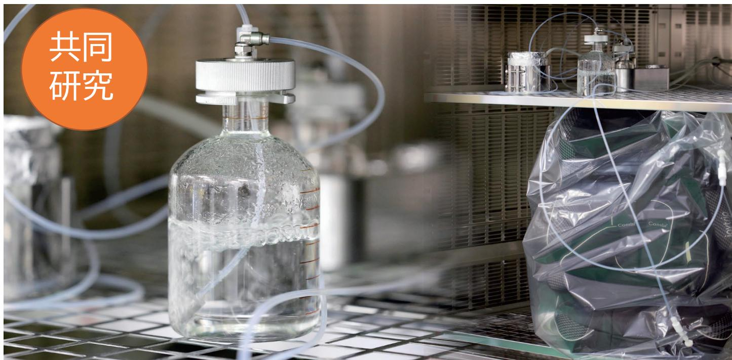
車室内放散試験時のサンプリングバッグ洗浄を効率化し、時短化を実現。
