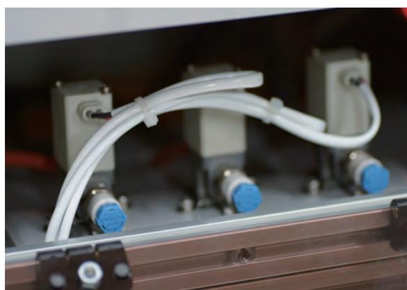
手動操作画面から各面の流量調整つまみを回し、フルメータにて設定します
