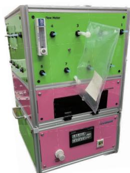
SRCは作業環境測定で使用するサンプリングバッグの洗浄（リサイクル）に特化した全自動洗浄装置です。1～5Lのバッグを最大3面24枚同時に洗浄することが出来ます。各洗浄面毎に異なるバッグサイズのものを洗浄することも可能です。
